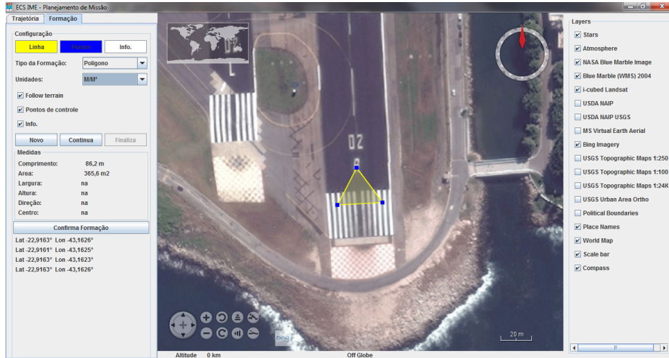
Figura 3: Módulo gráfico de planejamento da formação (etapas A1 e A2 do fluxograma)
