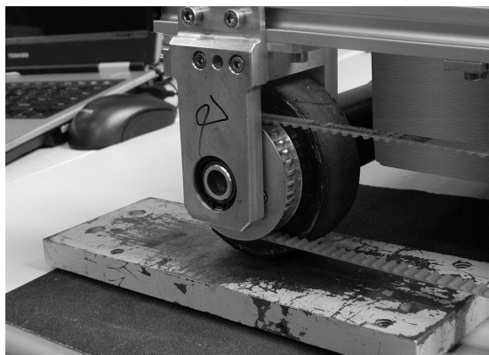
Figura 8: Ajuste do controlador de tração na superfície metálica.
