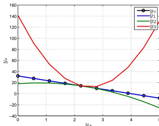
Figura 5: Resposta estática.  $y_v$  são os dados de validação,  $y_1$  a resposta do modelo com um termo,  $y_2$  o modelo com quatro termos e  $y_3$  o modelo com nove termos.
