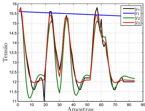
Figura 4: Simulação livres.  $y_v$  são os dados de validação,  $y_1$  a resposta do modelo com um termo,  $y_2$  o modelo com quatro termos e  $y_3$  o modelo com nove termos.
