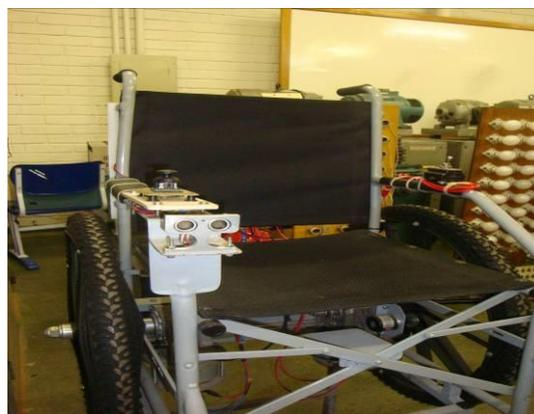
Figura 2 - Sensor de ultrassom para detecção de obstáculos
