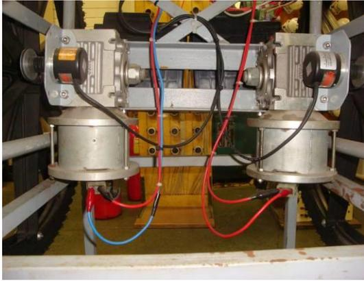
Figura 3 - Motores instalados na cadeira de rodas
