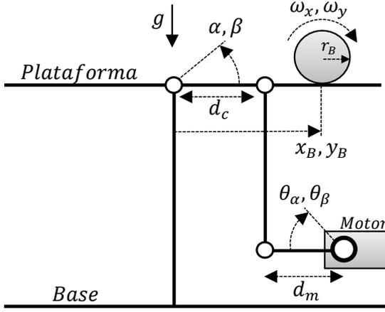
Figura 3: Esquemático do sistema *Ball and Plate*.
