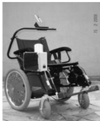
Figura 1. Protótipo da cadeira de rodas da UEL/CTU, Depto. Engenharia Elétrica. [Ferreira, Cervantes e Germanovix (2008)].
