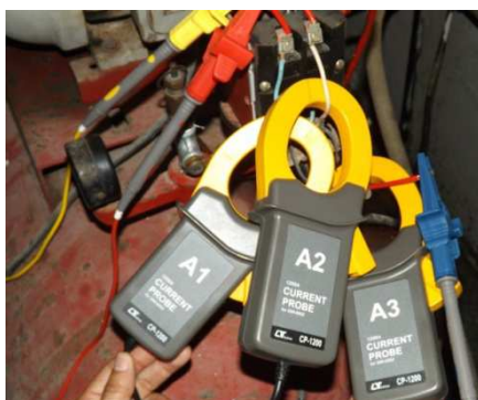
Figura 05-Forma de acoplamento do analisador ao motor.
