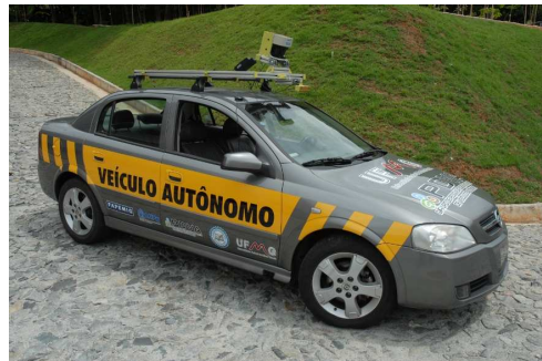
Figura 1: Carro Autônomo Desenvolvido na UFMG (CADU) - Automóvel comercial de modelo Chevrolet Astra Sedan 2003 adaptado para adquirir características de um robô autônomo.
