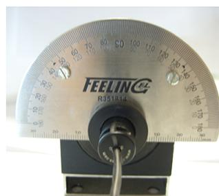
Figura 13: Foto do goniômetro acoplado ao suporte para LED.
