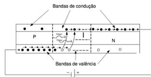
Figura 1: Ilustração da detecção de fótons e geração de pares elétron-buraco em um diodo PIN reversamente polarizado. Fonte: Notas de aula do Centro Universitário Fundação Santo Andre (FSA), Edson B. Ramos Férís e Laércio Alves Nogueira.
