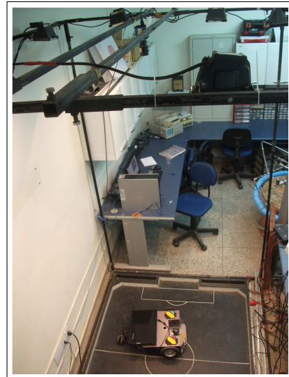
Figura 3: Estrutura utilizada para obter a covariância das rodas do robô.
