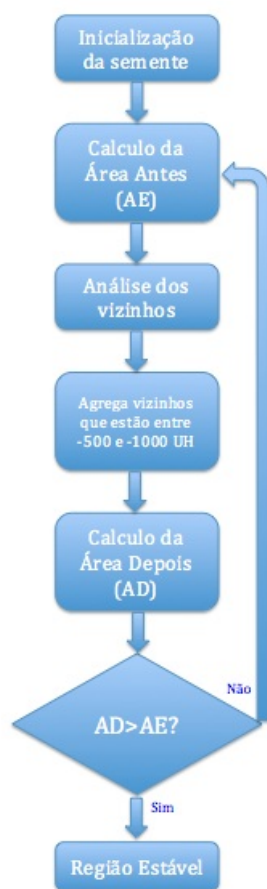
Figura 3: fluxograma do algoritmo de execução do Crescimento de Regiões 3D.
