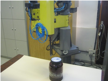
Figura 1: Robô SCARA retrofitado.
