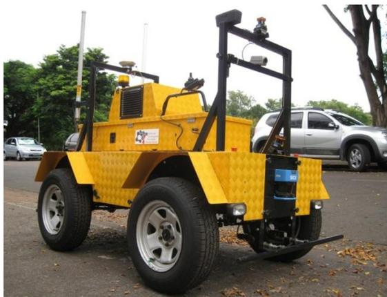
Figura 1. A plataforma robótica VERO.
