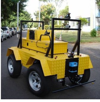
Figura 1: Veículo robótico do projeto VERO.
