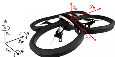
Figura 1: AR.Drone 2.0 e os sistemas de coordenadas adotados ( $\{w\}$  é o sistema de coordenadas global, e  $\{b\}$  é o sistema de coordenadas do veículo).
