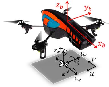
Figura 2: Relação entre os sistemas de coordenadas da imagem, do AR.Drone e global.
