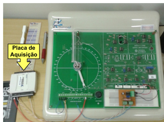
Figura 2: Kit didático Datapool e placa de aquisição de dados.
