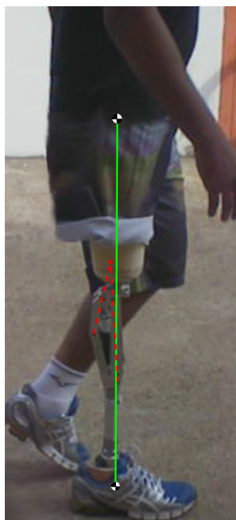
Figura 5: Foto de um paciente amputado utilizando o protótipo ilustrando o posicionamento da linha de carga (em verde) em relação ao centro instantâneo de rotação (ponto de encontro entre as linhas pontilhadas em vermelho).
